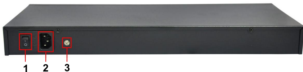
Рис. 7 Коммутатор SW-71602/L2, разъемы и кнопки на задней панели
